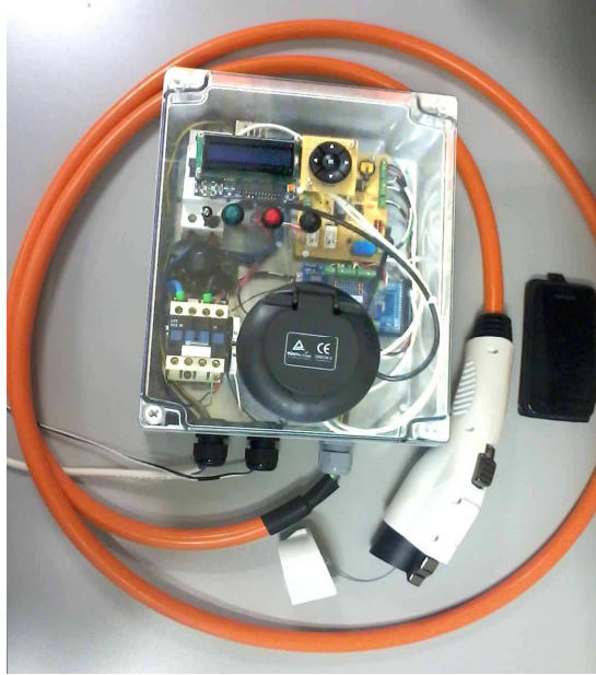
Figura 6. Foto actual del prototipo desarrollado del cargador
