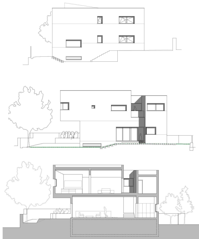
Figura 5: Fachadas Este, Sur y Sección de la vivienda
