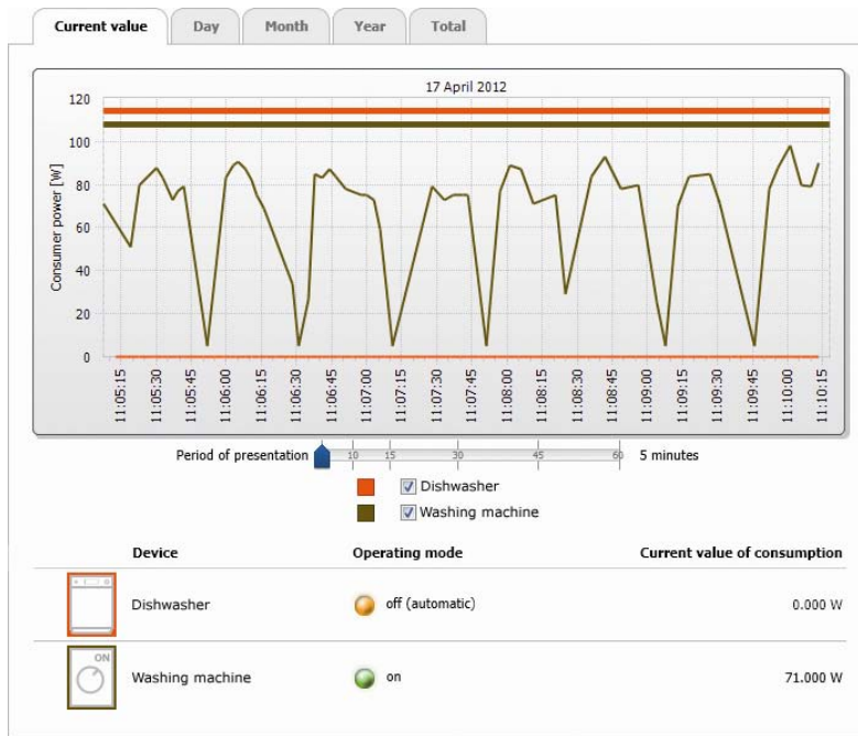
Figura 6. El balance energético indica la duración de operación y el nivel de carga de varias cargas controladas remotamente.
