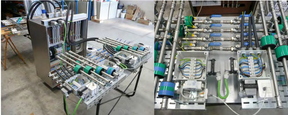
Figura 12. Módulos completos, con la red de doble anillo interior/externo, y equipos intermedios de conexión para cada módulo, así como entre cada módulo jurídico debe existir posibilidad de conexión.
