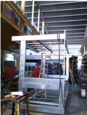
El hecho de que los elementos metálicos se hayan realizado en su totalidad en base a chapa plegada exprofeso, adecuándose a las dimensiones exigibles por cálculo nos permite una construcción con un mínimo de residuos materiales, incluso muchos elementos proceden de la reutilización de piezas de otro fin.<sup>2</sup>
